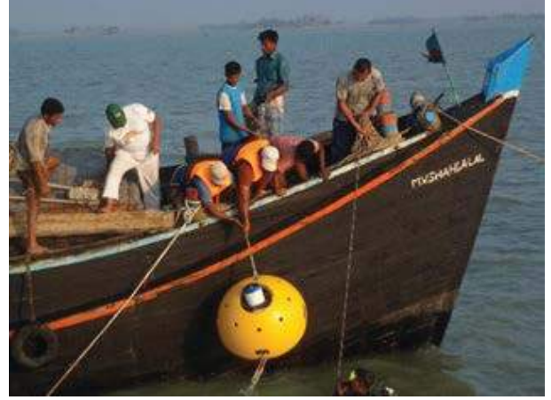
ডিপ্লমেন্ট অফ ADCP হাইড্রোগ্রাফিক ডাটা: নদীর শোভের ডাটা সংগ্রহের জন্য ADCP ডিপ্লয়মেন্ট করা হয় কুতুবদিয়া চ্যানেলে
